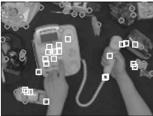
図 1 視覚的文脈を用いた動作学習：動作と関係のある視覚的特徴（ \square ）と動作と関係のない特徴（ \circ ）を区別し動作カテゴリーを学習する。
